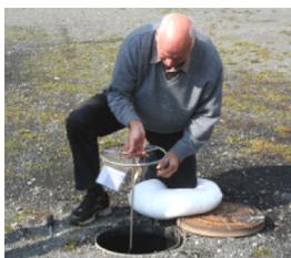
1. Nach Entfernen von Deckel und Isoliersverschluss wird die Zähleranlage unter leichtem Drehen herausgezogen.
